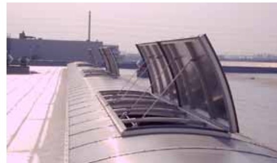
产品名称：电动排烟天窗（弧形双联杆型） 窗体性能：铝合金窗体（粉末喷涂），16mm聚碳酸酯板 驱动设备：电动开窗器，消防联动+日常通风
