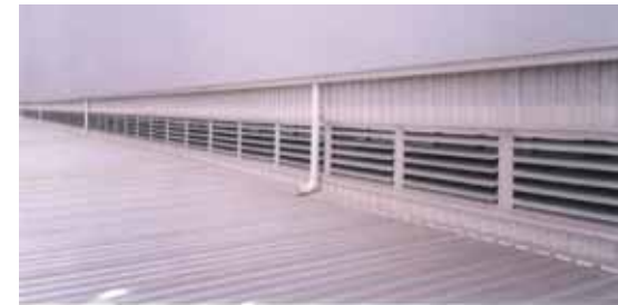
产品名称：电动排烟天窗（一字双开型） 窗体性能：铝合金窗体（粉末喷涂），6+0.76pvb+6钢化夹胶玻璃 驱动设备：电动开窗器，消防联动+日常通风 注：面板也可配置聚碳酸酯板、铝板
