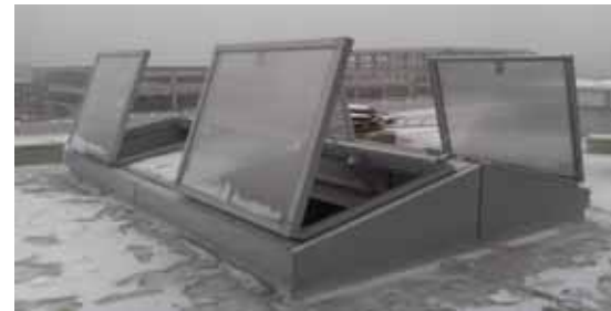
产品名称：气动排烟天窗（三角形，CO2气源） 窗体性能：断热铝合金窗体（氟碳喷涂），16mm 聚碳酸酯采光板 驱动设备：自锁式气缸，CO2气源（68℃自动触发），CO2集控箱，消防联动+日常通风 管道系统：紫铜管 注：面板也可配置安全玻璃、铝板
