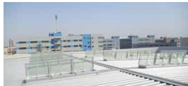
产品名称：电动排烟天窗（一字单开型） 窗体性能：断热铝合金窗体（粉末喷涂），6+9A+6+0.76pvb+6钢化中空夹胶玻璃 驱动设备：电动开窗器，消防联动+日常通风 注：面板也可配置聚碳酸酯板、铝板
