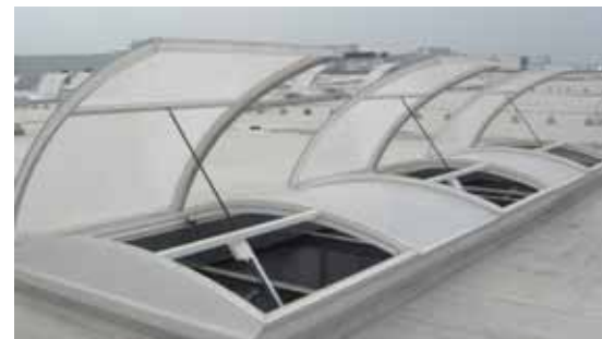
产品名称：电动排烟天窗（弧形单杆型） 窗体性能：铝合金窗体（粉末喷涂），10mm聚碳酸酯板 驱动设备：电动开窗器，消防联动+日常通风
