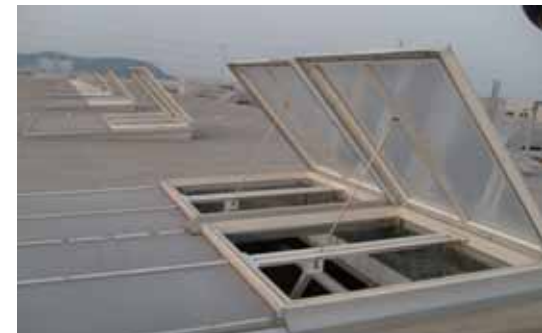
产品名称：气动排烟天窗（一字型，压缩空气气源） 窗体性能：断热铝合金窗体（粉末喷涂），10mm+6mm双层聚碳酸酯采光板 驱动设备：自锁式气缸，压缩空气气源，消防联动+日常通风 管道系统：紫铜管 注：面板也可配置安全玻璃、铝板
