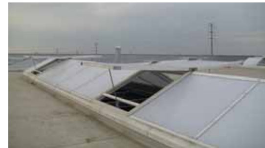
产品名称：电动排烟天窗（三角形） 窗体性能：断热铝合金窗体（粉末喷涂），10mm+20A+10mm双层聚碳酸酯采光板 驱动设备：电动开窗器，消防联动+日常通风 注：面板也可配置安全玻璃、铝板
